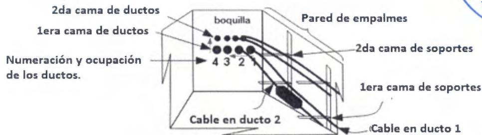
**Figura 1.** Ocupación de ductos y soportes de cables en pozos con una pared de empalme.
