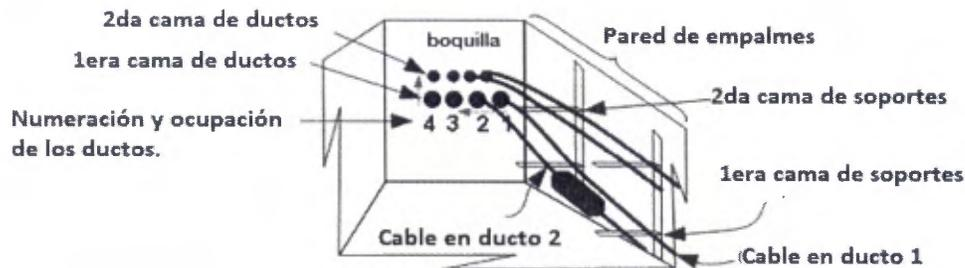
Figura 3 Diagrama de ductos dentro de un pozo
