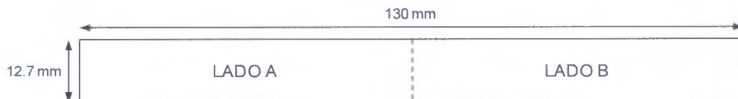
Figura 3.- Dimensiones de la etiqueta para cables multipar.
